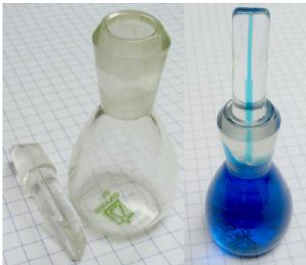
Σχήμα 1 - Πυκνόμετρο (Πηγή: Wikimedia Commons)
