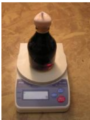
Σχήμα 2 – Πυκνόμετρο με δείγμα μαύρης μύρας σε ζυγαριά
