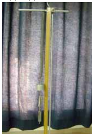
Σχήμα 1. Διατάξεις για προσδιορισμό της σταθερής των ελατηρίων.
