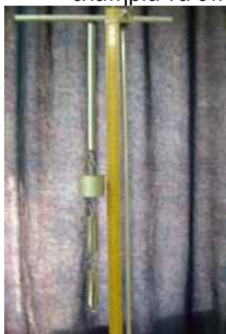
Σχήμα 1. Διατάξεις για προσδιορισμό της σταθερής των ελατηρίων.
