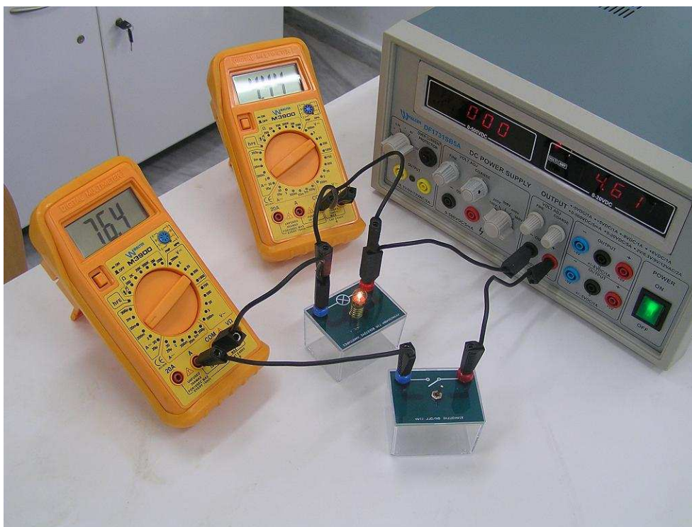
Κύκλωμα για την χαρακτηριστική καμπύλη λαμπτήρα.
