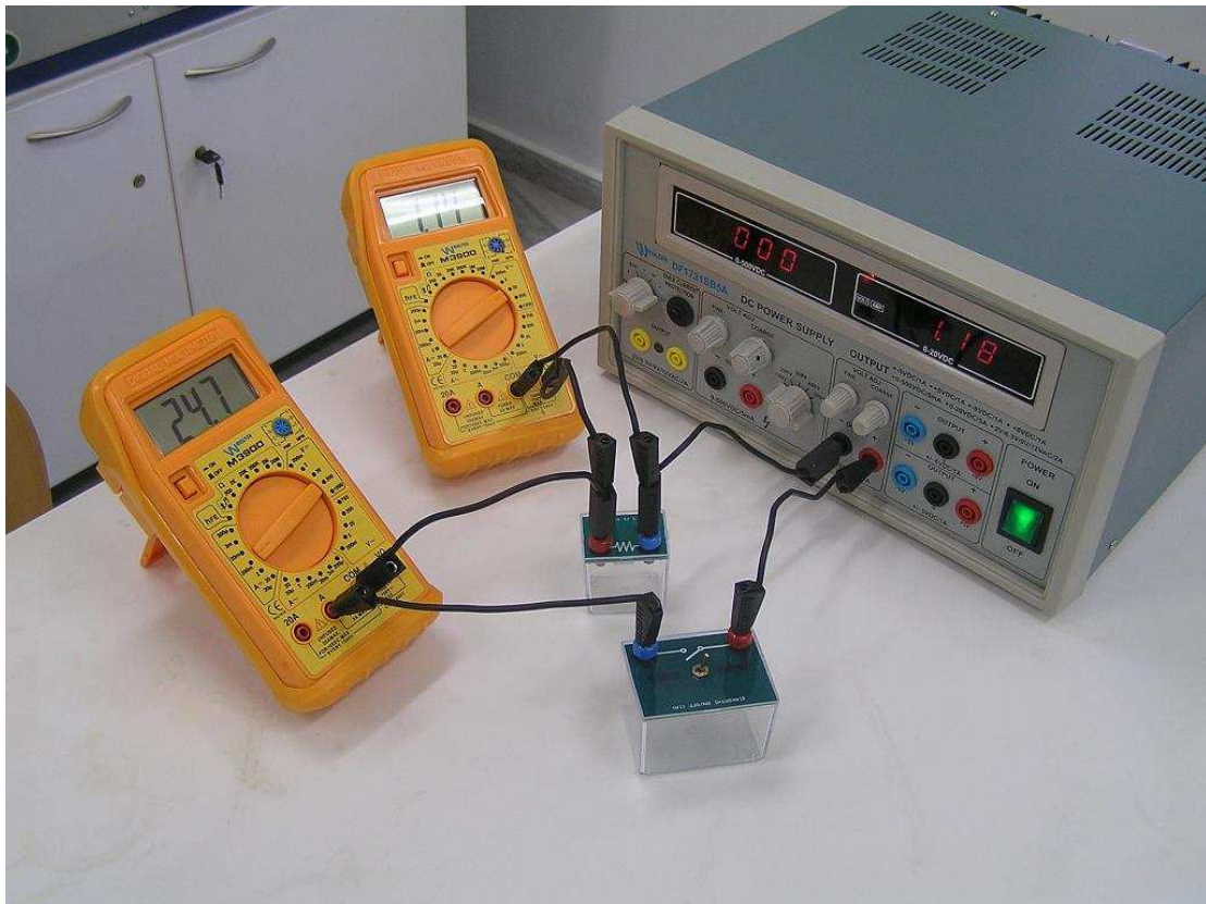
Κύκλωμα για την μελέτη της χαρακτηριστικής καμπύλης αντιστάτη.
