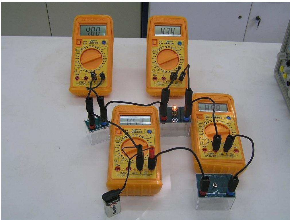
Ενεργειακή μελέτη κυκλώματος DC με πηγή αντιστάτη και λυχνία.
